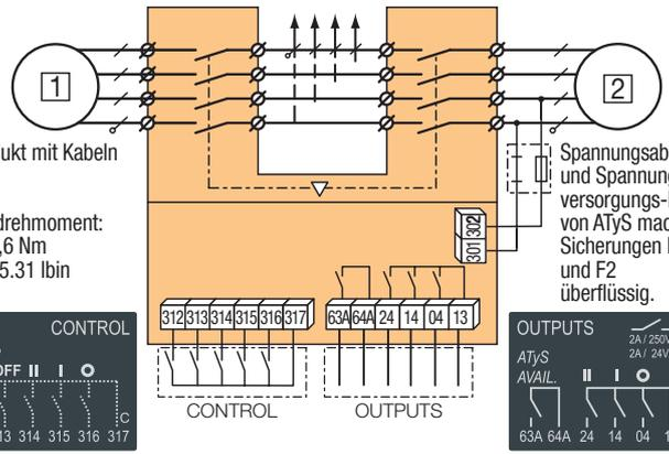
Schließen Sie das Produkt mit Kabeln 1,5 bis 2,5 mm<sup>2</sup> an.
