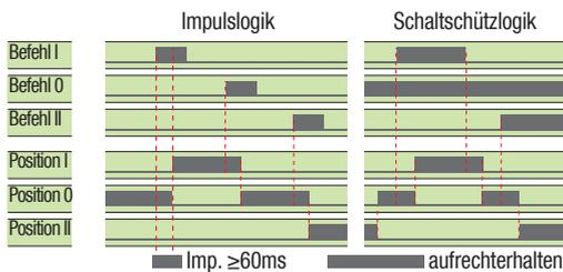
Schließen Sie Kontakt 312 mit Kontakt 317, um die Steuerung zu ermöglichen. Schließen Sie Kontakt 313 mit Kontakt 317, um das Produkt in die Position 0/OFF zu zwingen. Schließen Sie Kontakt 316 mit Kontakt 317, um die Schaltschützlogik zu aktivieren. Schließen Sie den entsprechenden Kontakt, um die gewünschte Position zu erreichen.
