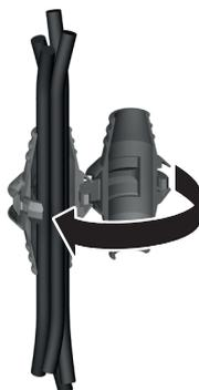
Schritt 4: Kabelbinder festziehen
