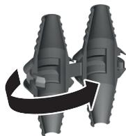
Schritt 2: Kabel festklemmen und Zentrierhülse an den Querschnitt anpassen
